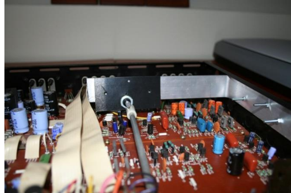
Bevestiging nieuwe schakelaar.
